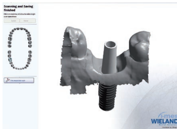
Abb. 10: Übertragung der Modellsituation mittels Scan-Aufbau.
