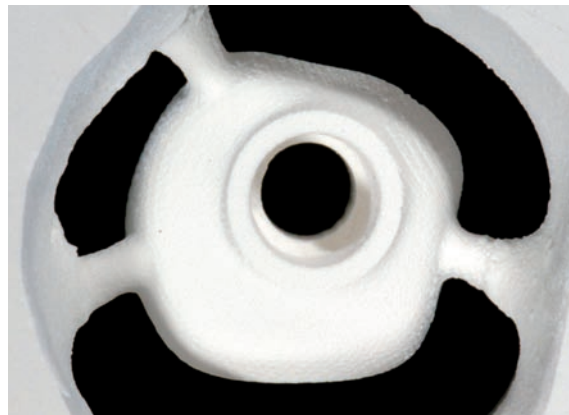
Abb. 18: Ausgefrästes individuelles Abutment aus ZENO® Zr B2.
