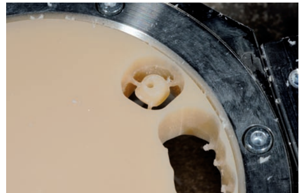
Abb. 7: Ausgefrästes Healing-Abutment aus ZENO® PMMA Discs der Farbe A.
