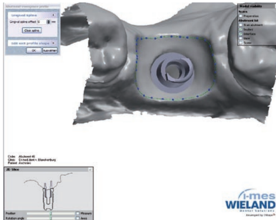
Abb. 11: Festlegen des Übergangs vom Aufbau zur Krone.
